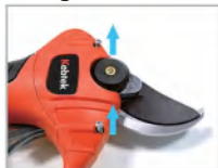
1. Retire los tornillos de la carcasa de la máquina;
