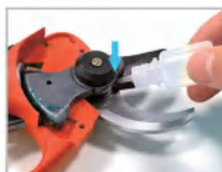
9. Vuelva a colocar la cuchilla y aplique aceite lubricante;
