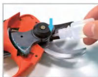
9. Remplacer la lame et appliquer de l'huile de lubrification.
