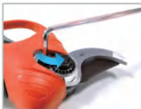
3. Retire los tornillos de la junta antiaflojamiento;
