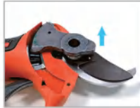
6. Entfernen Sie die Schwenkzähne;
