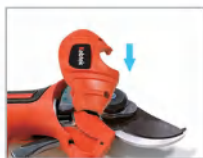
12. Installare il coperchio laterale dell'involucro e serrare le viti.
