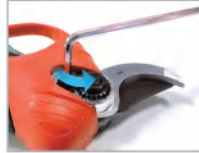
3. Entfernen Sie die Dichtungsschrauben;
