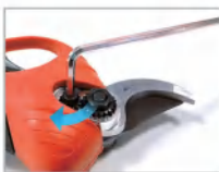
11. Installare le viti antiallentamento della guarnizione;
