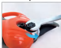
4. Retirer l'écrou denté ;
