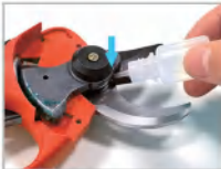
9. Setzen Sie die Klinge wieder ein und Schmieröl auftragen;
