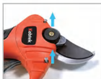
1. Retirer les vis du boîtier de la machine ;
