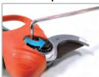
3. Rimuovere le viti antiallentamento della guarnizione;
