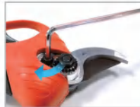
11. Montieren Sie die Schrauben zur Sicherung der Dichtung;
