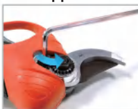
3. Retirer les vis du joint anti-desserrage ;
