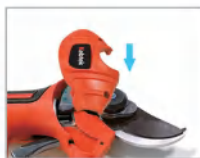
12. Installer le couvercle latéral du boîtier et serrer les vis.
