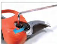
11. Instale los tornillos de la junta antiaflojamiento;
