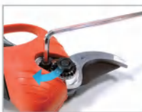
11. Installer les vis du joint d'étanchéité anti-desserrage.
